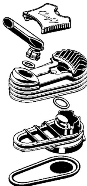
2. Снятие мундштука с крышки охлаждающего блока
