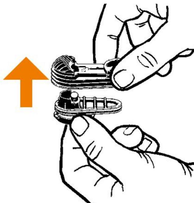
5. Снятие большого уплотнительного кольца основы охлаждающего блока
