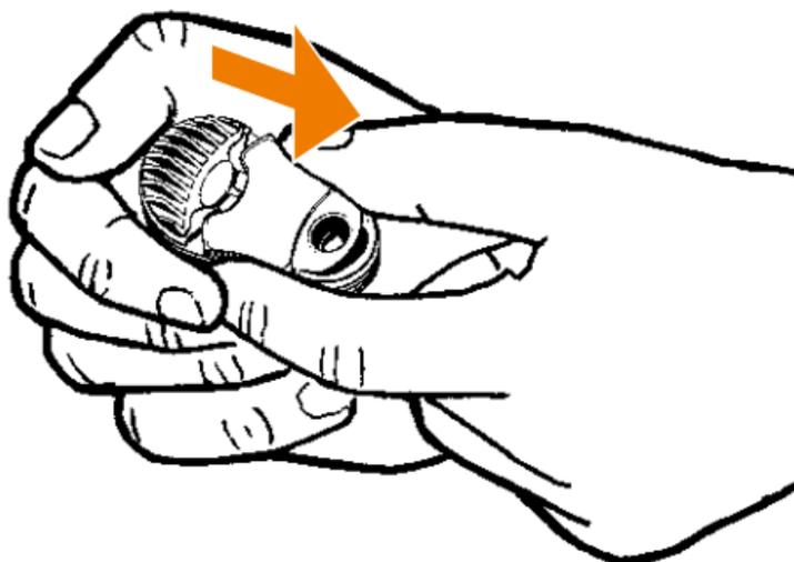
4. Снимите крышку охлаждающего блока с основы охлаждающего блока
