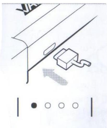
ПОДКЛЮЧИТЕ РАЗЪЕМ МИКРО USB К БАТАРЕЕ УСТРОЙСТВА, А ДРУГОЙ КОНЕЦ К ПОРТУ USB.
