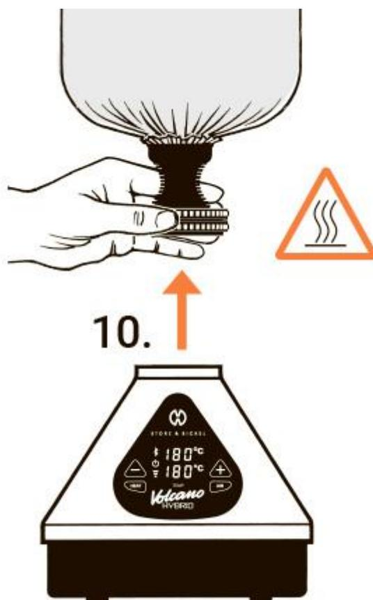
10. Отвинтите камеру вместе с прикрепленным к ней заполненным резервуаром
